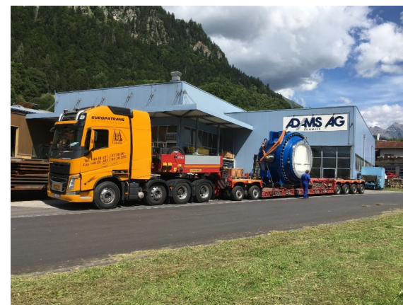
Kugelschieber Ø2000mm, 65t, Stensjön Kraftverk, Schweden
